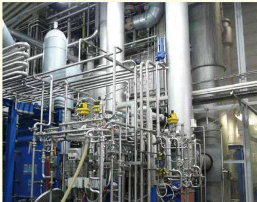
*Vakuum-Destillationsapparatur in einem Entalkoholisierungszentrum*
