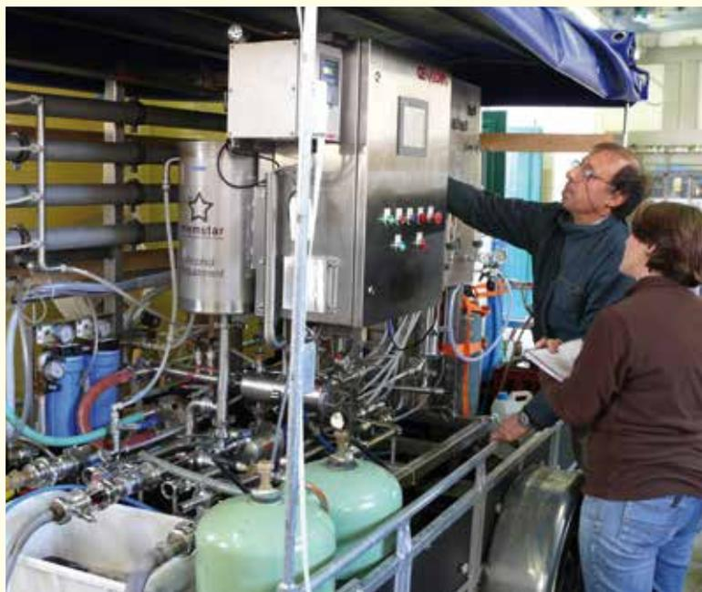
*Zweistufige Kombinationsanlage: Umkehrosmose plus osmotische Destillation*
