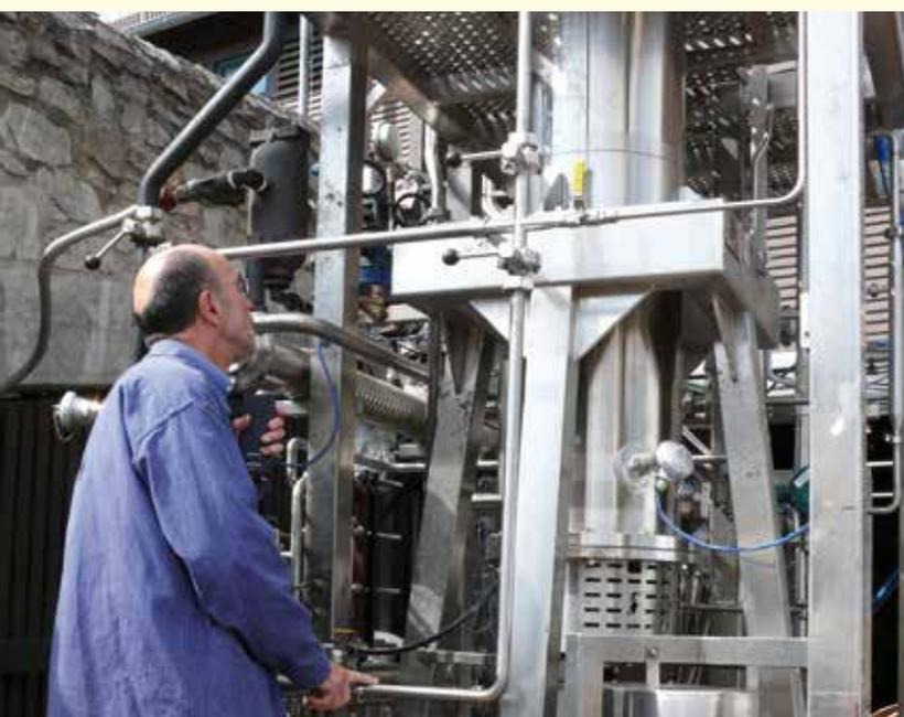
*Destillationsanlage „Spinning Cone Column“, halbrechts die stehende Vakuum-Kolonne*
