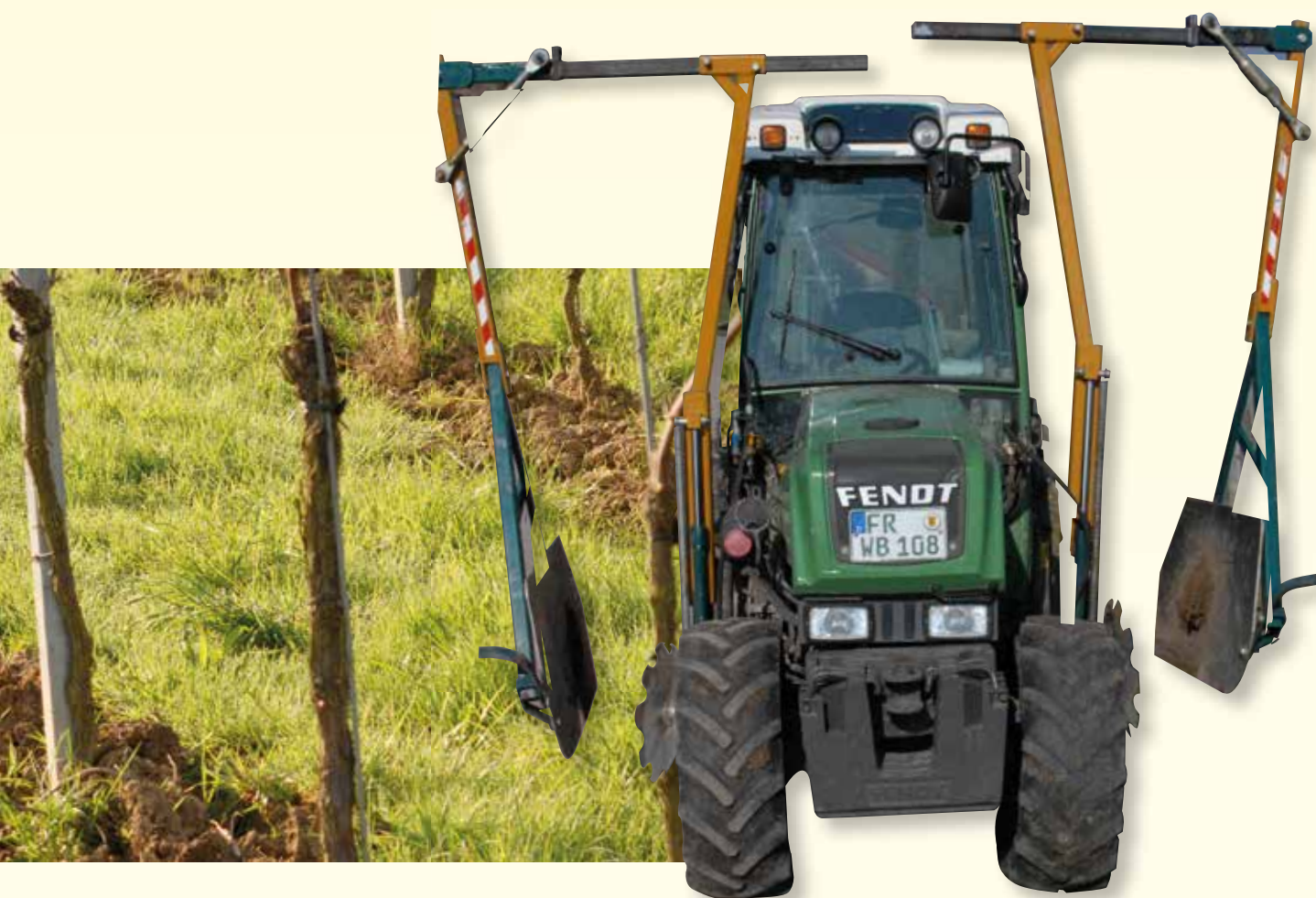
Scheibenpflug im Zwischenachsenanbau mit Prallblechen
