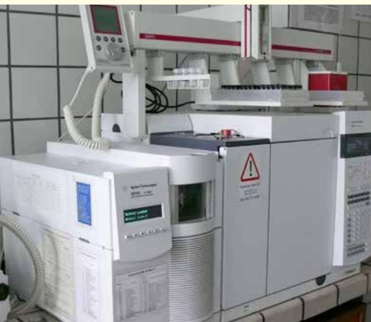
Abb. 1: Gaschromatograph mit Massenspektrometer
