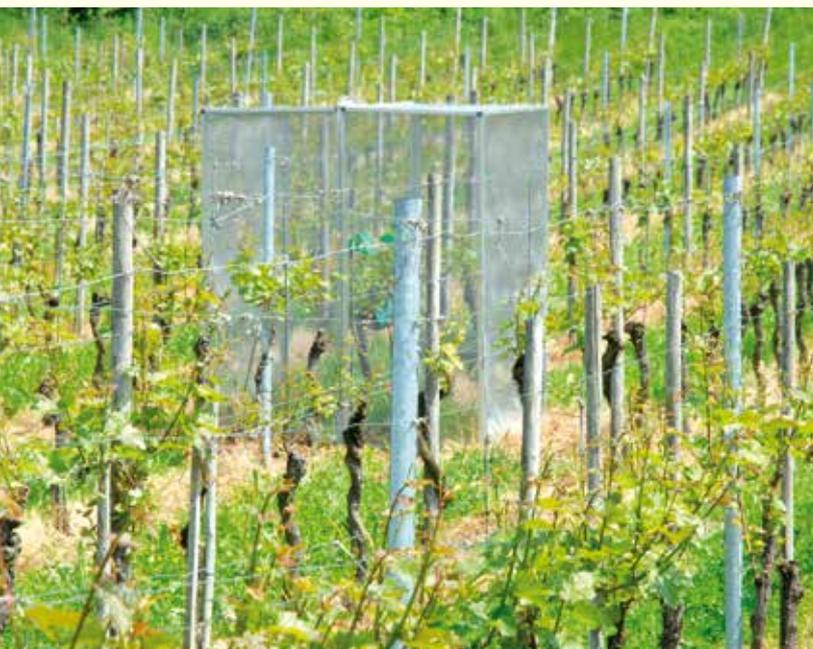
*Abb. 3: Versuchskäfig, mit dem am WBI die Effizienz der Pheromonwirkung im Gelände bestimmt werden kann.*
