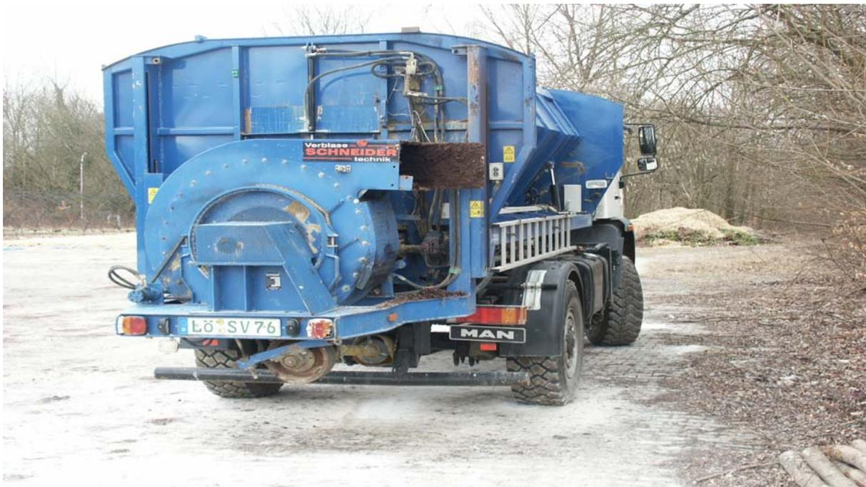
**Abb. 41: Spezialfahrzeug der Firma Schneider Verblasetechnik zur Kompost- und Mulchausbringung**
