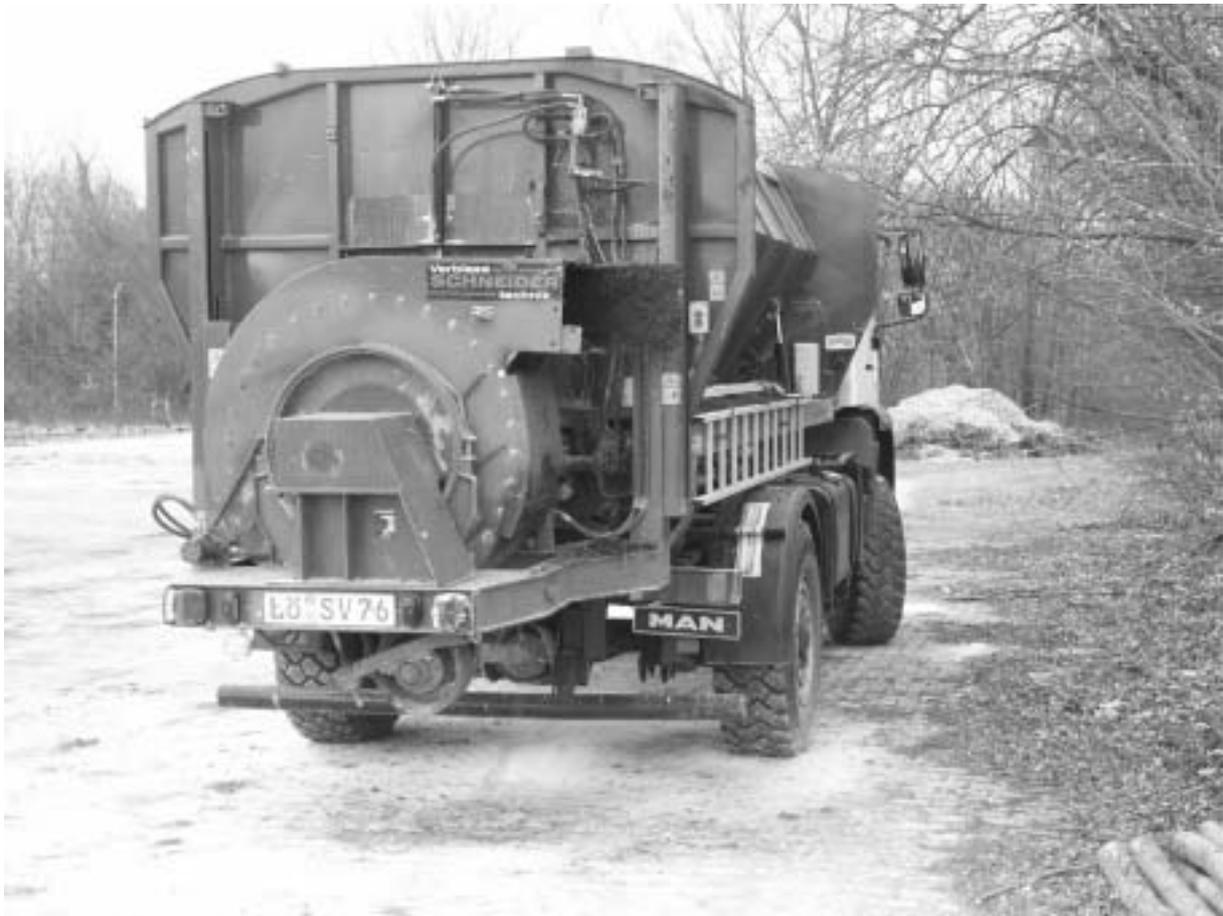
**Abb. 52: Spezialfahrzeug der Firma Schneider Verblasetechnik zur Kompost- und Mulchhausbringung**
