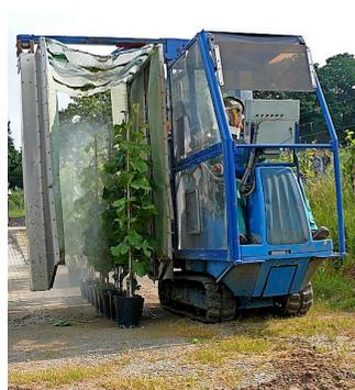
Bild 1: Das Parzellenspritzgerät von Schachtner im Versuch
