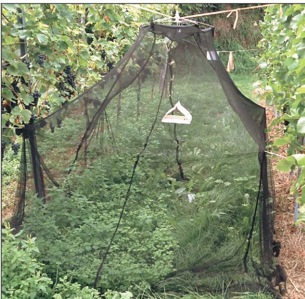
Versuchskäfig, mit dem am Staatlichen Weinbauinstitut die Effizienz der Pheromonwirkung im Gelände bestimmt werden kann. Bilder: Breuer
