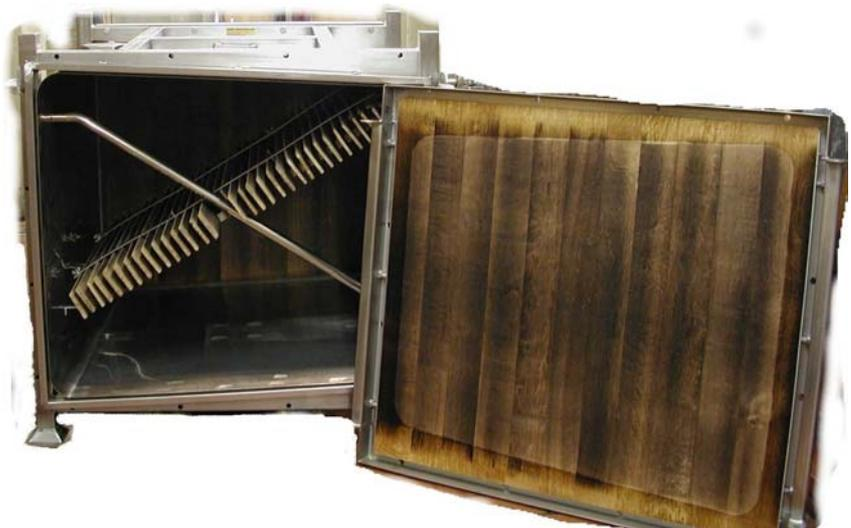
**Abbildung 2:** Stapeltanks mit innen liegenden Eichenholzplatten („inner staves“)
