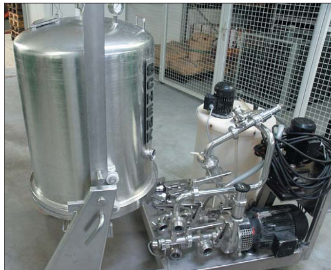
Beim Zentrifugal-Hochleistungs-Filter (ZHF) kann der Filtrations- kreislauf unterbrochen werden. Bilder: Zimmermann
