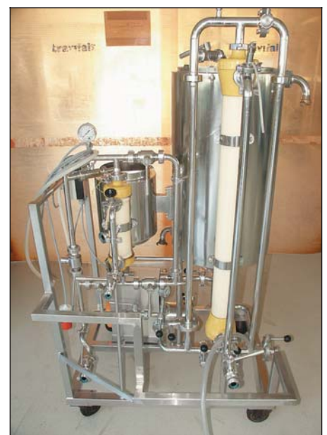
Mit dem Membranfilter lassen sich Weine direkt nach dem Abstich keimarm bis steril filtrieren.
