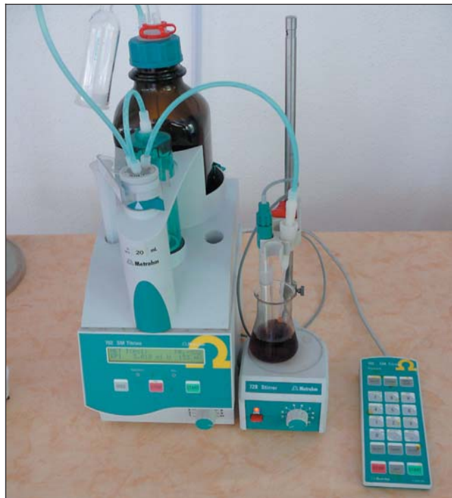
Eine Apparatur zur Titration der Schwefligen Säure. Sie arbeitet automatisch. Bild: Zimmermann
