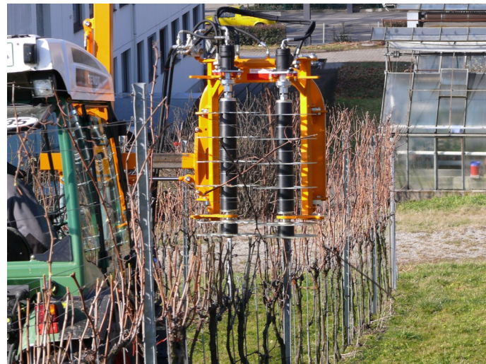
Abb. 4: Bei Dichtpflanzungen kann eine Vorschneidemaschine vorteilhaft eingesetzt werden.
