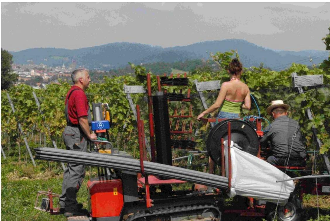
**Abb. 5: Maschinentechnik zur Installation des WHAILEX Schutznetzsystems**
