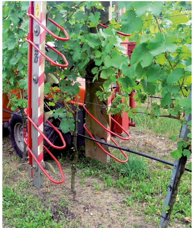
Abb. 4: Um die Hagel-schutznetze zu schonen, werden von derFirma ERO Abweiserbügel angeboten.
