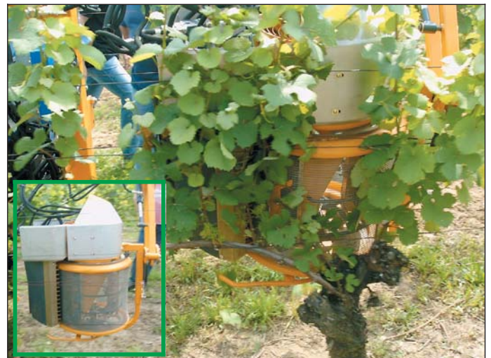
Der Binger-Entlauber (links) war eines der ersten Geräte mit Saug-Zupf-Technik; die gute Zugänglichkeit (Detailfoto) zur Reinigung ist ein Pluspunkt. Beim Pellenc-Entlauber messen Drucksensoren den Anpressdruck für die automatische Zeilenführung.
