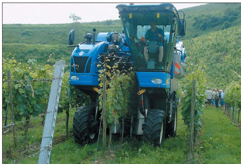
Die VL-Baureihe der Braud-Traubenvollernter ist mit insgesamt 14 einzeln aktivierbaren Schüttelstäben ausgestattet, was die Lesegutqualität verbessert und die Rebstöcke schont.
