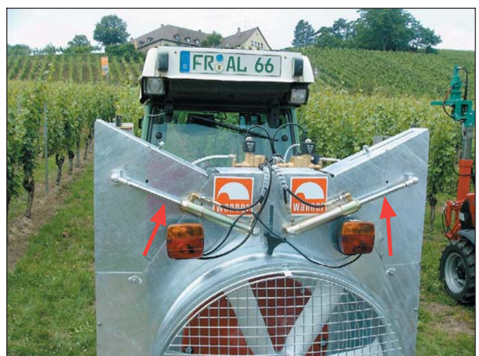
Zwei Geräte für den Einsatz in Querterrassen: Der Überzeilen-Laubschneider von Binger (links) kann über die Rebzeile ausgehoben und auf die Rebzeile auf der anderen Seite geführt werden. Durch hydraulisch verstellbare Luftleitbleche kann beim Wanner-Sprühgerät mit Zweistoff-Kreislauftechnik (rechts) die Luftstromführung einfach und schnell der Laubwand angepasst werden.
