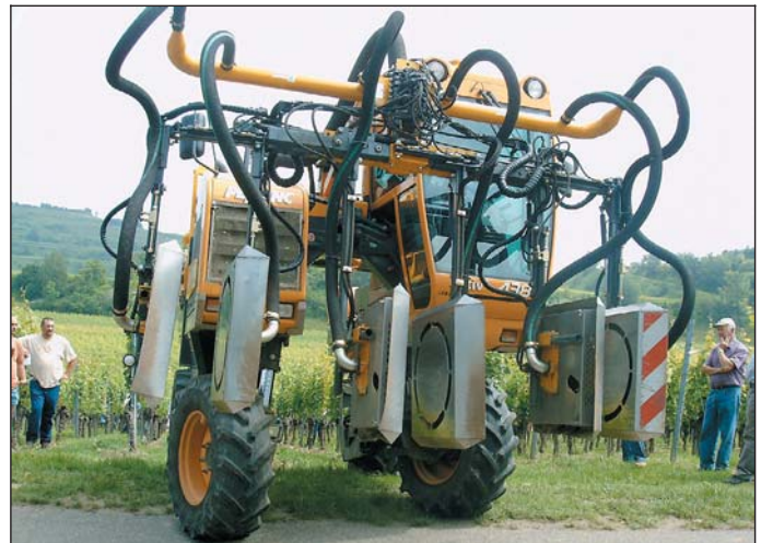
Links: Das 60 kg schwere Saug-Zupf-Entblätterungsgerät von Stockmayer saugt die Rebblätter an eine Lochwalze und streift sie dann an einer Bürstenwalze ab. Rechts: Der dreireihige Siegwald-Entlauber mit beidseitigen Ablassscheiben arbeitet mit bis zu 1 bar Überdruck, ist sehr schlagkräftig und kann so den optimalen Einsatzzeitraum nutzen; er benötigt mindestens 50 PS Schlepperleistung.
