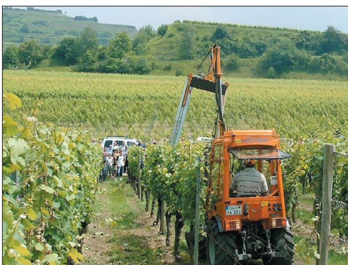
Zwei Geräte für den Einsatz in Querterrassen: Der Überzeilen-Laubschneider von Binger (links) kann über die Rebzeile ausgehoben und auf die Rebzeile auf der anderen Seite geführt werden. Durch hydraulisch verstellbare Luftleitbleche kann beim Wanner-Sprühgerät mit Zweistoff-Kreislauftechnik (rechts) die Luftstromführung einfach und schnell der Laubwand angepasst werden.
