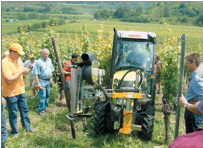
Links: Das 60 kg schwere Saug-Zupf-Entblätterungsgerät von Stockmayer saugt die Rebblätter an eine Lochwalze und streift sie dann an einer Bürstenwalze ab. Rechts: Der dreireihige Siegwald-Entlauber mit beidseitigen Ablassscheiben arbeitet mit bis zu 1 bar Überdruck, ist sehr schlagkräftig und kann so den optimalen Einsatzzeitraum nutzen; er benötigt mindestens 50 PS Schlepperleistung.
