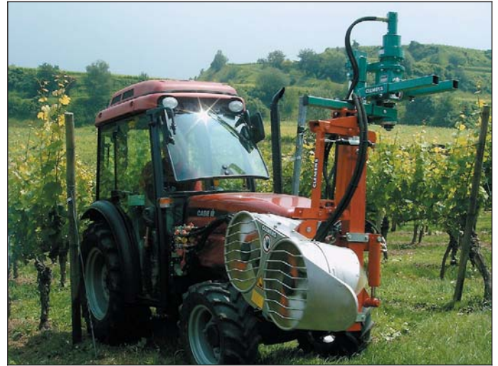
Das Ero-Entlaubungsgerät (links) arbeitet ebenso wie der Clemens-Entlauber, der zwei Rotoren aufweist, nach dem Saugen-Schneiden-Prinzip, beide Geräte können nach links und rechts geschwenkt werden. Bilder: Autoren
