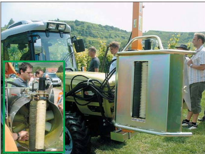
Der Binger-Entlauber (links) war eines der ersten Geräte mit Saug-Zupf-Technik; die gute Zugänglichkeit (Detailfoto) zur Reinigung ist ein Pluspunkt. Beim Pellenc-Entlauber messen Drucksensoren den Anpressdruck für die automatische Zeilenführung.
