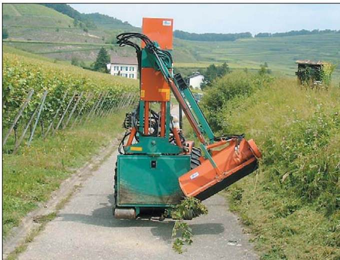
Neu von Leible Landtechnik in Durbach: Der hydraulisch angetriebene Böschung-Schlegelmulcher BMO1.
