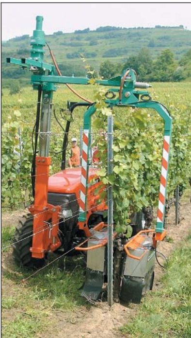
Das Clemens-Sprühkammergerät wurde speziell für das chemische Entfernen der Stammtriebe – auch in Querterrassen – konstruiert.
