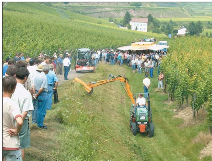
Dieser Auslegemulcher von Fischer, Gemmrigheim, erreicht den Böschungsbewuchs noch in 5,20 m Höhe.
