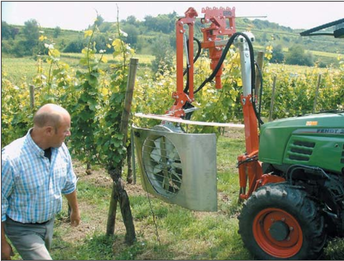
Das Ero-Entlaubungsgerät (links) arbeitet ebenso wie der Clemens-Entlauber, der zwei Rotoren aufweist, nach dem Saugen-Schneiden-Prinzip, beide Geräte können nach links und rechts geschwenkt werden. Bilder: Autoren
