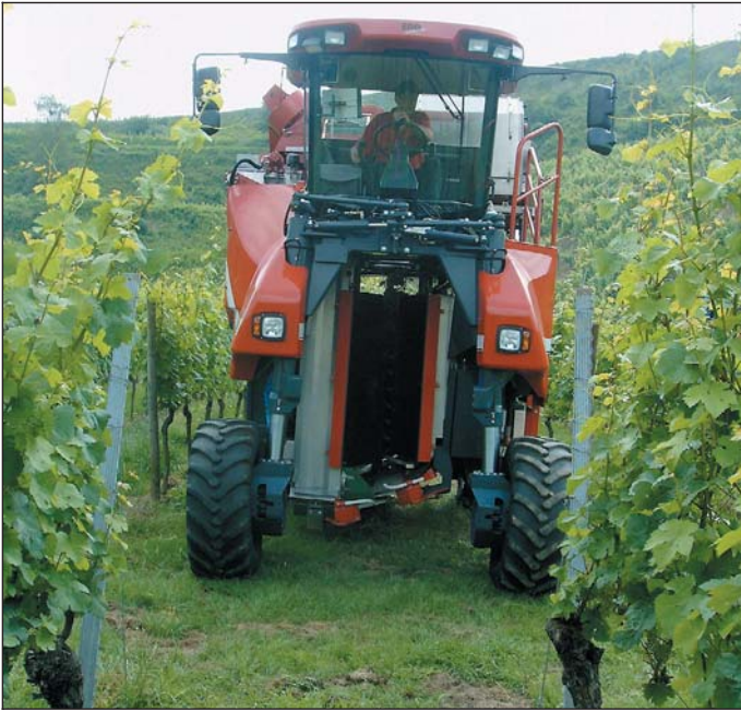
Links: Der Ero-Grapeliner besitzt eine ultraschallgesteuerte Lenkung und ein Schnellwendeprogramm namens Quick-Steer. Die neueren Maschinen von Gregoire (rechts) sind mit dem ARC-Erntekopf ausgestattet, der die mechanische Belastung der Trauben und Stöcke reduziert.
