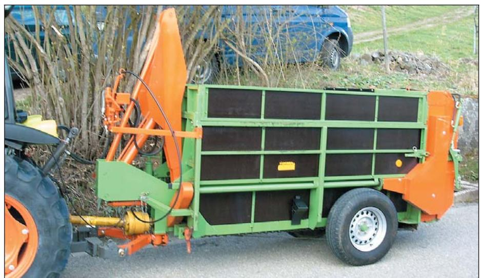
Der Stroh-Streuer von Fischer – hier mit Kurzdeichsel – besitzt eine hydraulische Schubwand, mit der das Material nach hinten transportiert wird.
