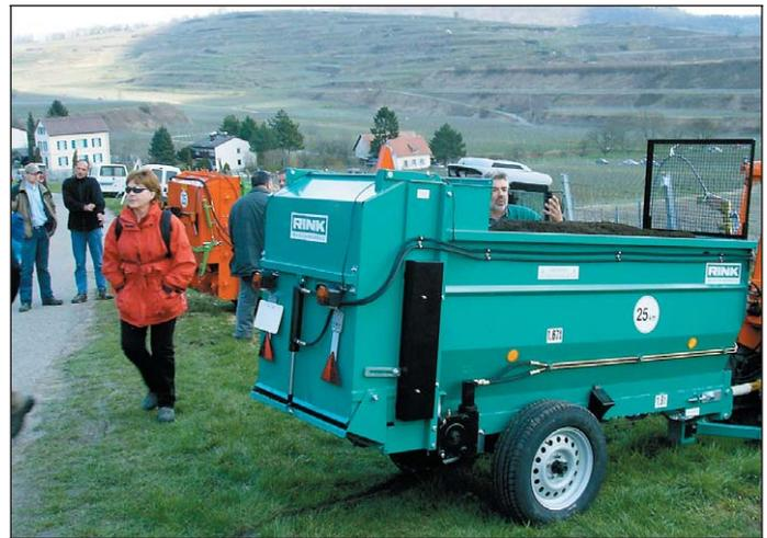
Beim Rink-Kompoststreuer wird der Kratzboden hydraulisch, die Streuwalzen mechanisch angetrieben.
