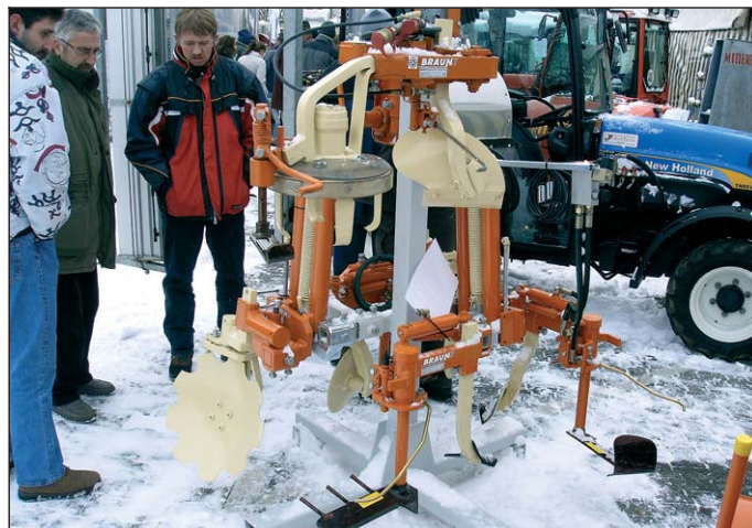
Links: Fräsen mit Vorgrubbern beugen der Sohlebildung im Boden vor. Rechts: Unterstockräumer können mit zahlreichen verschiedenen Werkzeugen wie Scheibensech, Risser, Spindelmäher, Kreisler ausgestattet werden. Bilder: Huber
