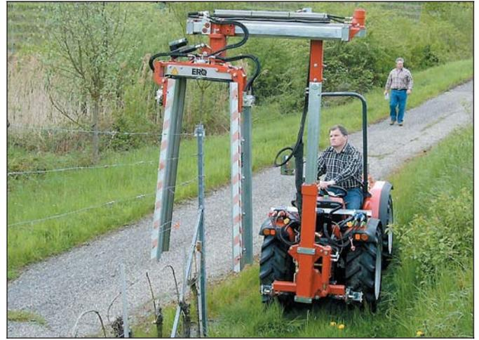
Laubschneider mit Verschiebeeinrichtung von ERO.
