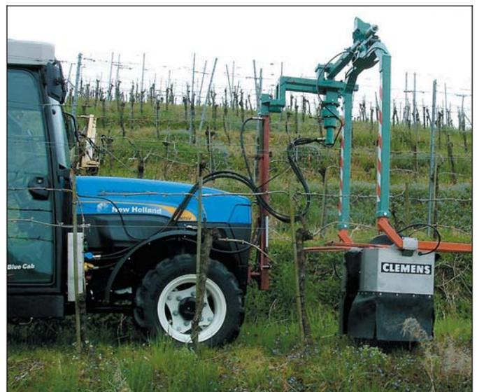
Für das chemische Ausbreiten wurde die Clemens-Sprühkammer vorgeführt. Mit 100 bis 200 l/ha Ausbringungsmenge wird ein zur Beseitigung von Stockausschlägen zugelassenes Produkt innerhalb der Sprühkammer gezielt auf Stockausschläge gesprüht. Die Kammer ist an einem speziellen Rahmen aufgehängt.
