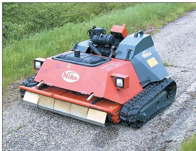
Eine Besonderheit war der funkferngesteuerte „Robo-Flail“-Böschungsmulcher, der von der Firma Niko in erster Linie für Autobahnböschungen entwickelt wurde.
