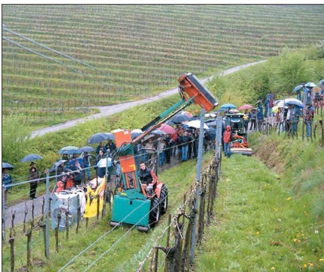
Der extra für die Querterrassen entwickelte Böschungsmulcher BM 01 von der Firma Leible Landtechnik, Durbach, hat eine maximale Ausladung von 2,60 Metern auf beide Seiten. Die Spezialmaschine kann eine Arbeitshöhe bis zu 4,10 Metern erreichen. Bilder (5): Huber
