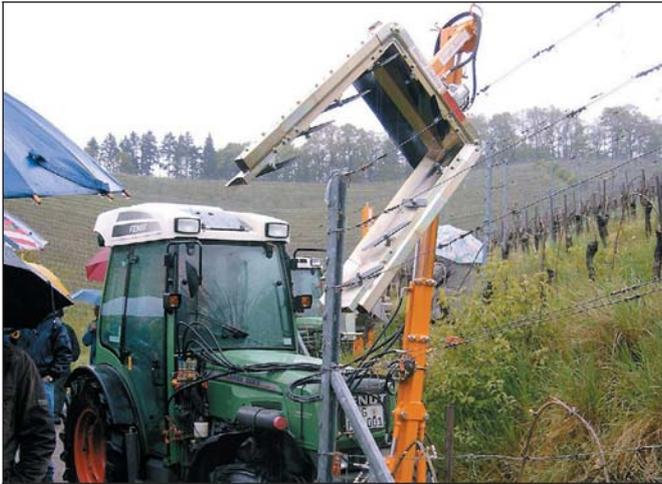
Laubschneider mit Schwenkvorrichtung von Binger.
