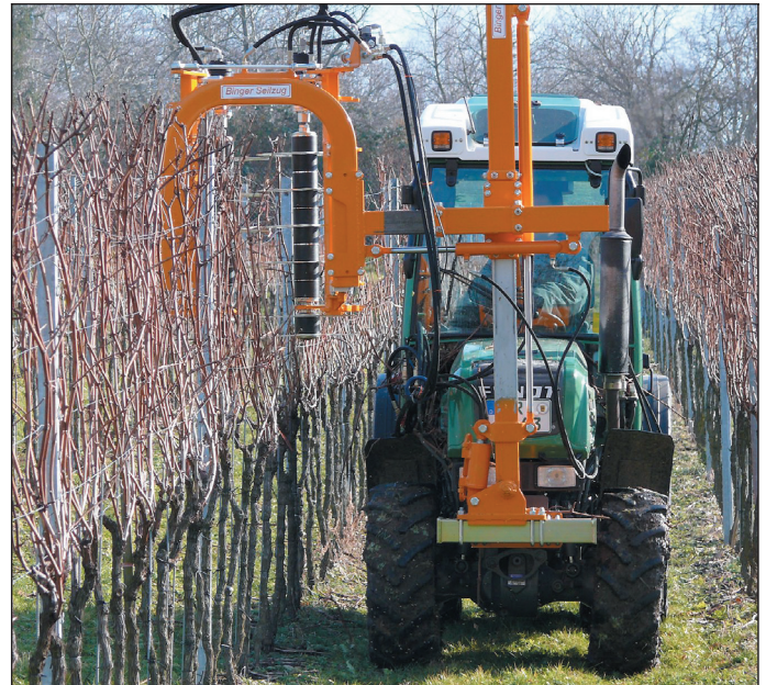
Beim Anbau eines Vorschnittgeräts ist bei leichten Traktoren unbedingt auf ein entsprechendes Gegengewicht am Heck zu achten.
