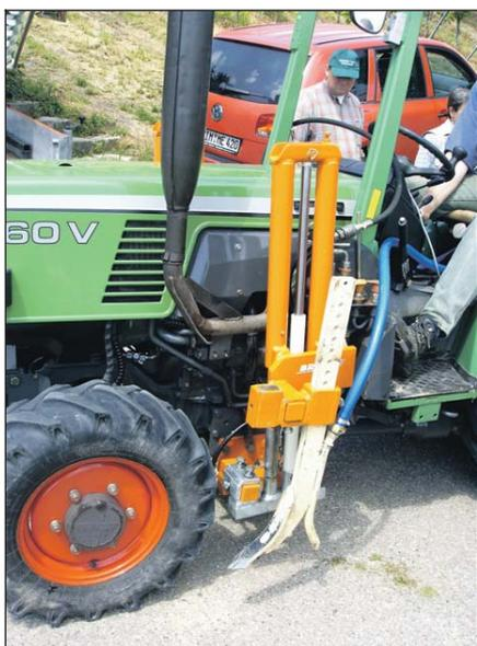
Die Reihenbewässerung von Braun (Meiselgrubberstiel mit Rohr) leitet Wasser aus dem mitgeführten Nachläufer-Tank (Sprühgerät) direkt zum Rebstock.
