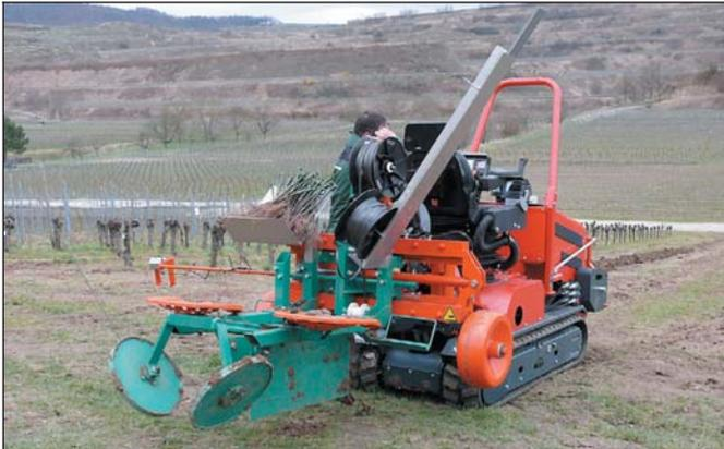
Bild 7: Bei der Low-cost-Pflanzmaschine von Clemens gibt eine zuvor gespannte Schnur die Position der Rebzeile vor.
