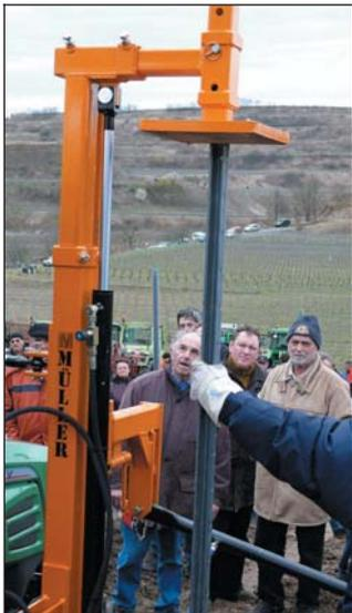
Bild 11: Großes Interesse erweckte der Pfahldrücker mit hydraulischer Seiten- und Neigungsverstellung im Einsatz.
