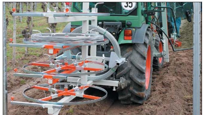
Bild 10: Mit einer Drahtabwickelvorrichtung können gleichzeitig mehrere Drähte abgespult werden.
