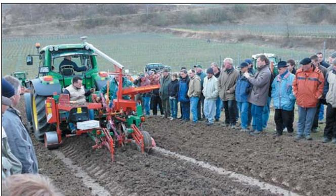
Bild 9: Eine GPS-unterstützte Pflanzmaschine kann das Auszeilen deutlich erleichtern.
