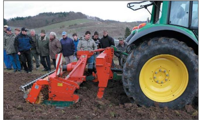
Bild 6: Pflanzvorbereitungskombination bestehend aus Schichten-grubber, Kreiselegge und Güttlerwalze.
