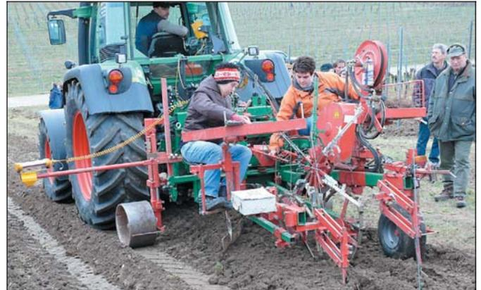
Bild 8: Maschinelles Pflanzen von Pflanzreben und Ausbringen der Pflanzpfähchen ist in einem Arbeitsgang möglich.
