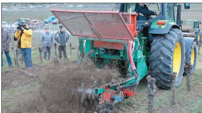
Bild 3: Eine Stockrodemaschine im Einsatz: Durch die nachgelagerte Doppelwalze werden die Rebstöcke vom anhaftenden Boden befreit.
