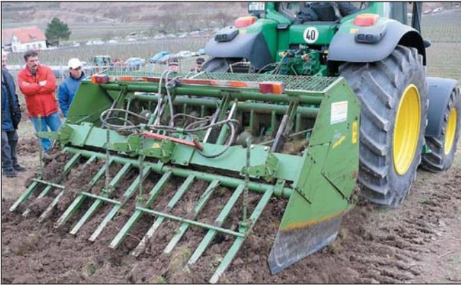
Bild 5: Spatenmaschine zur tiefen, schonenden Bodenbearbeitung. Ideal im Spätherbst bei abgetrockneten Böden.
