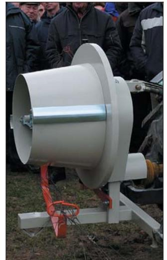
Bild 2: Praktisch ist das zapfwellenbetriebene Drahtaufwickelgerät der Firma Müller.
