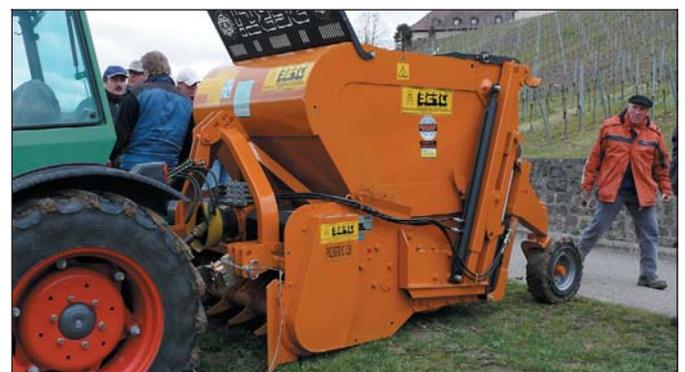
Bild 4: Beim Berti-Picker zum Aufsammeln und Zerkleinern von Rebholz für die thermische Verwertung erfolgen Auflösen und Zerkleinern in einem Arbeitsgang.
