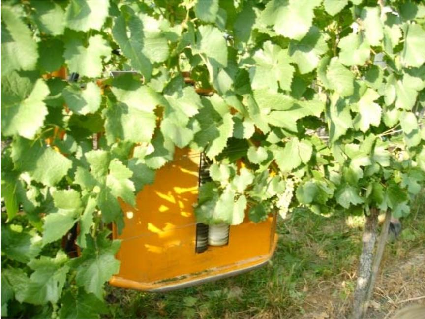
*Bild 2: Der neue Binger Seilzug Entlauber EB 490 saugt und zupft die Blätter aus der Traubenzone*
