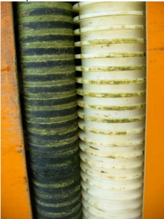
*Bild 3: Kernstück des neuen Binger Entlaubers EB 490, die sauggebläse-unterstützten gegenläufigen Walzen. Eine gefederte Gummi- und eine gerillte Kunststoffwalze.*
