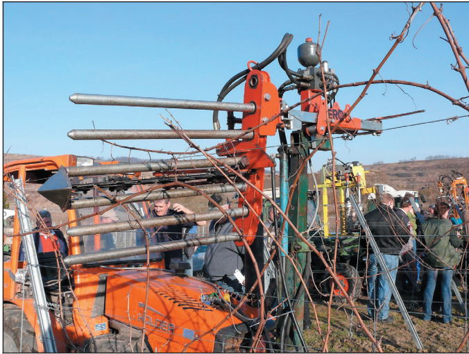
Bild 4: Vorschneider der Firma ERO mit drehbaren Stäben und Doppelmesserschneidbalken.
