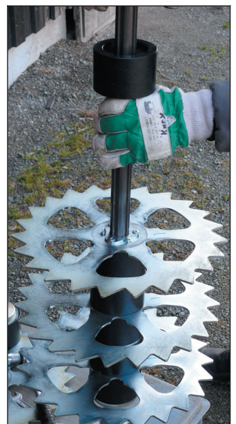
Bild 2: Flexible Anordnung der Scherscheiben beim Typ VSL07 von Binger Seilzug.
