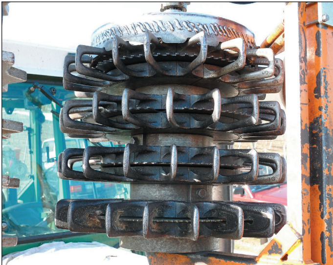
Bild 1: Schneidwalze mit Kreissägeblättern beim Typ VS 98 S von Binger Seilzug.
