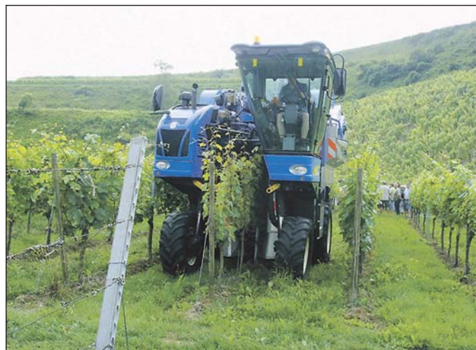
Bei schwach ausgelegten Endverankerungen sollte das Schüttelwerk erst im dritten Rebstock der Zeile eingeschaltet werden.
