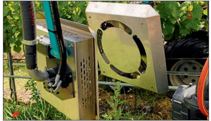
Bild 4: Um eine ideale Arbeitsqualität zu erreichen, sollte das Siegwald-Gerät mit 0,35 bar Druck und einer Fahrgeschwindigkeit von 3,2 km/h eingesetzt werden.
