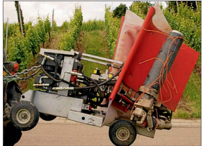
Bild 10: Der Fadenrotormulcher Greenmaster von Ladurner mulcht die Gasse, den Unterstockbereich und entfernt die Stocktriebe im unteren Bereich.
