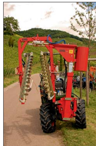
Bild 6: Der Ero-Laubhefter verfügt über eine hydraulische Einstellung der Seitenneigung am Hubrahmen.
