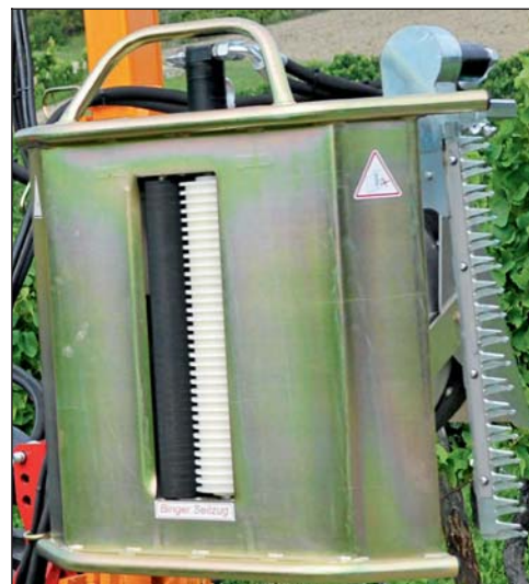
Bild 1: Der Vorentspitzer des Binger-Entlaubers ist an allen Binger-Entlaubern nachrüstbar.
