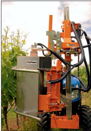
Bild 3: Aufgrund der einfachen Bauweise besteht beim Provitis-Entlauber nur geringer Wartungsbedarf.
