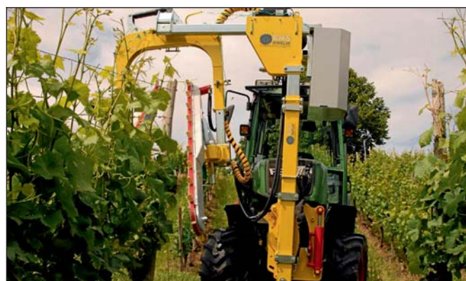
Bild 7: Das patentierte Verschlussystem des Klammerautomaten von KMS-Rinklin erlaubt ein schnelles Nachladen mit bis zu 5000 Klammern.
