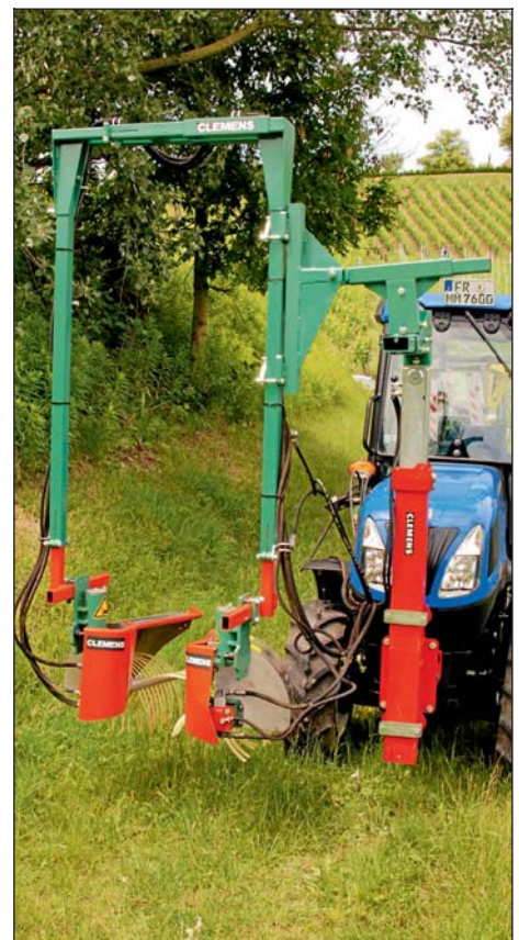
Bild 11: Die Mähbürste Multi-Clean von Clemens ist mit robusten Schnüren ausgestattet und hat einen vibrationsarmen Lauf.
