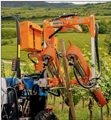
Bild 8: Der Provitis-Laubhefter richtet die Rebtriebe mit seinem breiten Band optimal auf.
