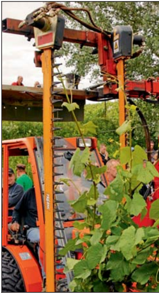
Bild 9: Der Überzeilen-Laubschneider von Huber-Landtechnik sorgt mit seinen heckscherenartigen Messern für einen sauberen Schnitt.
