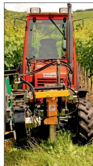
Bild 2: Das 60 Kilogramm schwere Saug-Zupf-Entblätterungsgerät von Stockmayer saugt die Blätter mit einer Lochwalze an und streift sie mit einer Gummiwalze ab.
