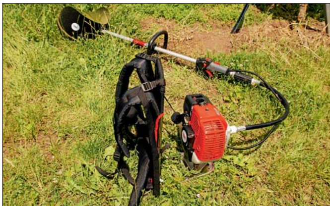
Bild 5: Der handgeführte Tiger-Entlauber ist besonders für kleine Parzellen geeignet.
