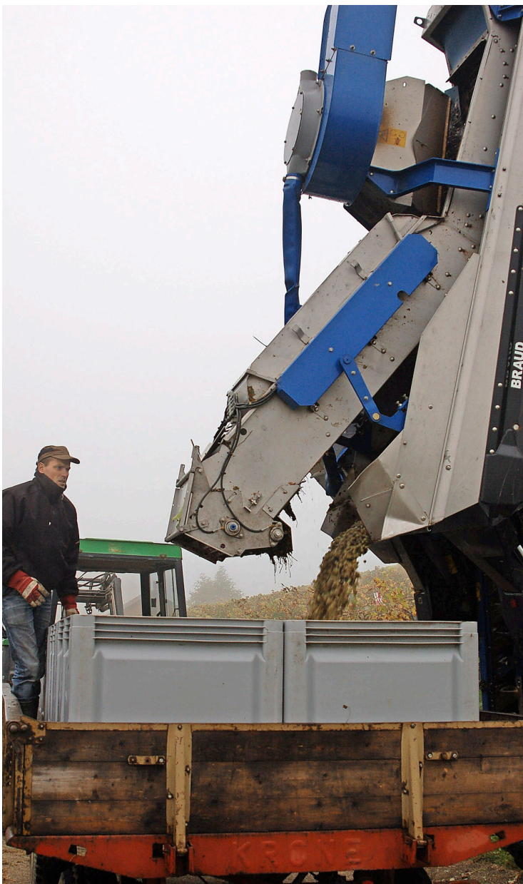
Die maschinelle Lese als Teil der Arbeitskette ist beim Minimalschnittsystem zwingend notwendig – allerdings stellt sie an die Rebflächen spezielle Ansprüche.
