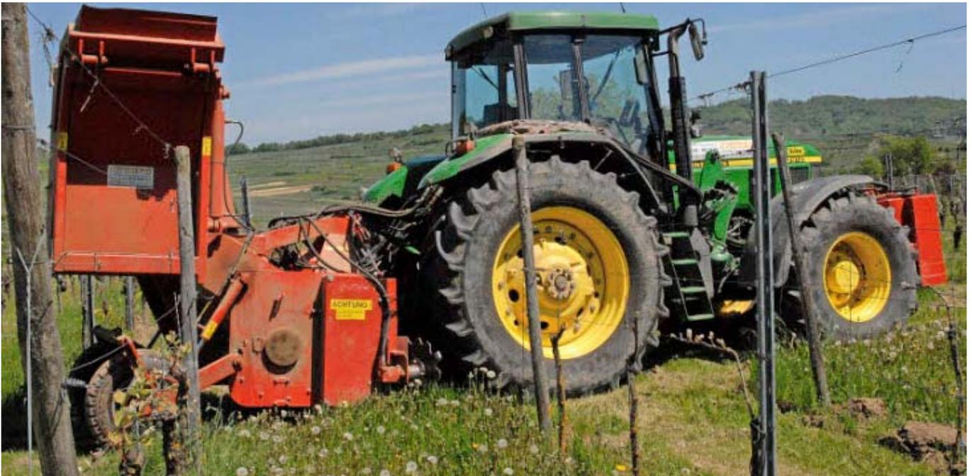
Abb. 1: Häcksler zur Aufnahme und Zerkleinerung gerodeter Rebstöcke.
