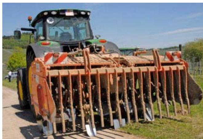
Abb. 2: Spatenmaschine Tortella mit einer Arbeitstiefe von 60 cm.
