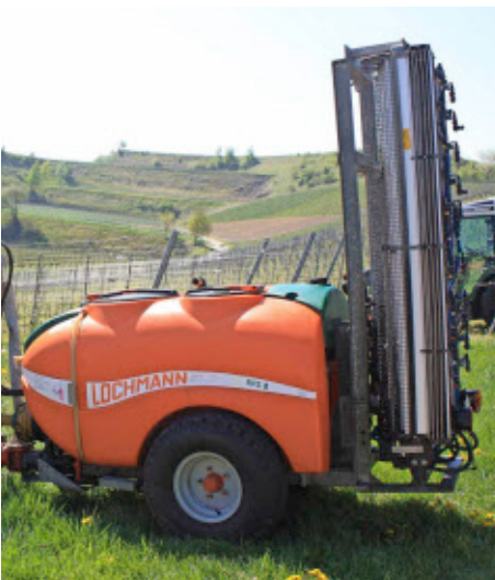
Die Lochmann RPS 8 mit dem Querstrom- gebläse der Firma Weber aus Bodman.
