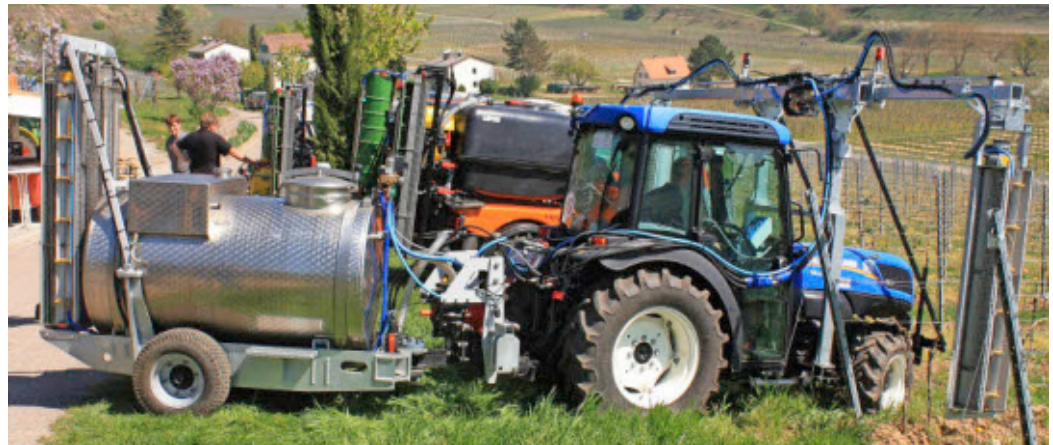
Der Freilauber EL Überzeilensprayer mit Querstromlüftern im Zwischenachs-anbau.
