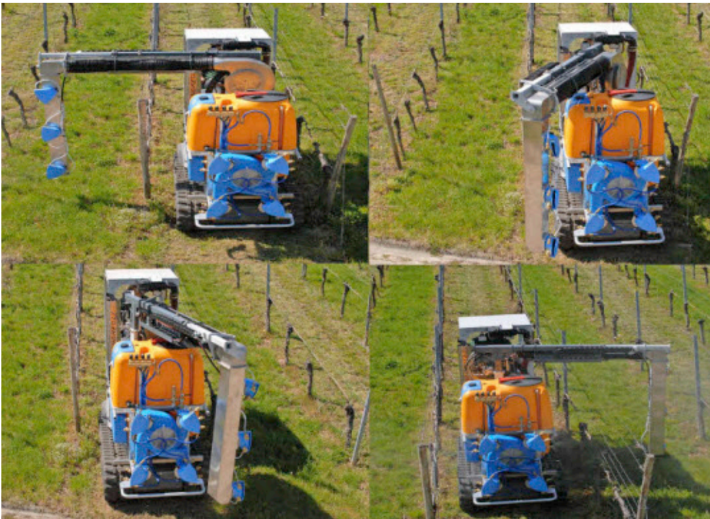
Raupe der Firma HoLaTec beim Drehen des Spritzarms der umgebauten Vicar-Spritze.
