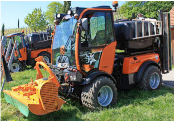
Neuheit: Der Holder C 270 mit hydrostatischem Fahrtrieb und stufenloser Fahrgeschwindigkeitsregulierung mit 500-Liter-Tankaufbau und Tangentialgebläse der Firma Lipco.
