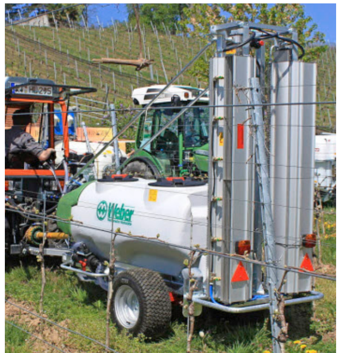
Der Nachläufer mit dem Querströmergebläse der Firma Weber hat einen kompakten feuerverzinkten Grundrahmen.
