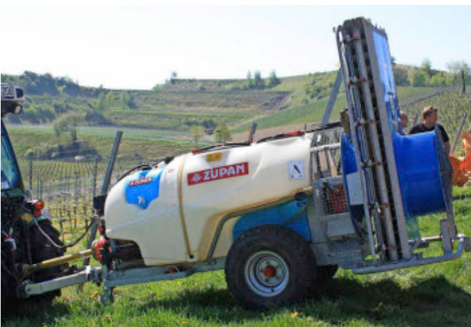
Die Zupan ZM 800 DT mit einer vom Hersteller empfohlenen Sprühfläche von 15 ha.
