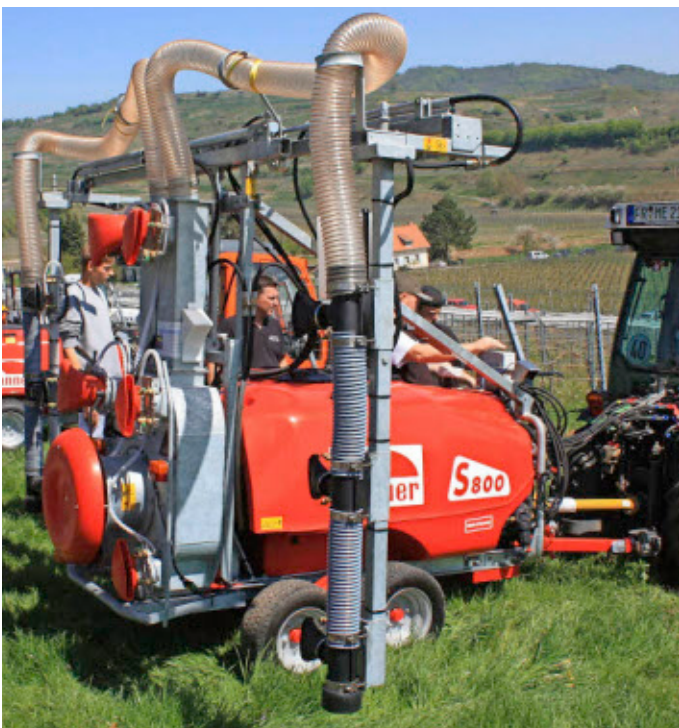
Dieses Überzeilengerät mit Radialgebläse und Luftzuleitungsrohren zu den Düsen stellt die Firma Wanner her.
