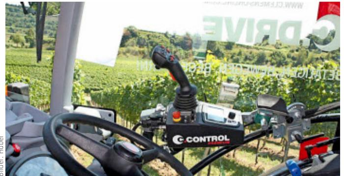
Bild 1: Bei der C-Control-Steuerung werden alle Bewegungs- und Arbeitsfunktionen von Anbaugeräten mit einem Joystick bedient.
