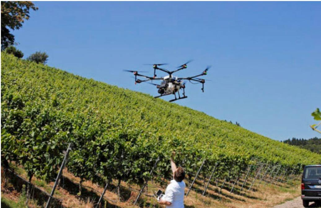
Bild 8: Manuel Becker von der LWVO führte die Sprühdrohne DJI Agras MG-15 für die Applikation von Pflanzenschutzmitteln im Steillagenweinbau vor.
