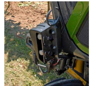
Bilder 3a und 3b: Die beiden Reichhardt-Ultraschallsensoren waren an der Front des Fendt 210 VA Vario S3 montiert. Das Lenksystem kommuniziert über die Fendt-TIM-Schnittstelle mit dem Schlepper und kann ihn somit selbstständig durch die Rebgassen führen, indem es die Rebzeilen durch Sensoren abtastet.
