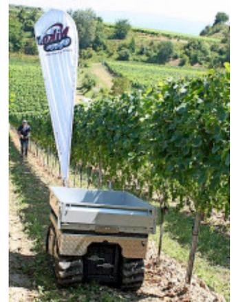
Bild 7: Ein ferngesteuerter, vollelektrischer Geräteträger mit Raupenlaufwerk der Niko-Maschinenbau.
