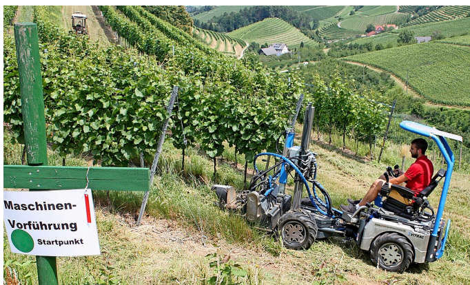
Bild 1: Die Maschinenvorführung zeigte Optionen zur herbizidfreien Unterstockbearbeitung in querterrassierten Weinbauanlagen.
