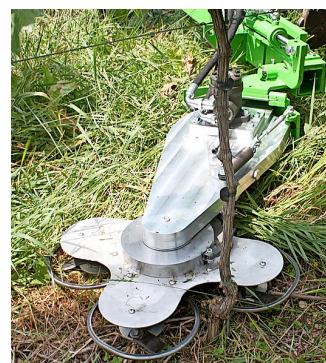
Bild 4: Beim Greencut 2060 der Firma Irsara handelt es sich um ein kreuzförmiges Mähwerk mit hydraulischem Antrieb.
