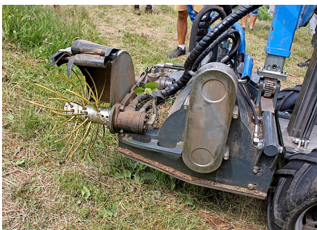
Bild 8: Durch einen besonders schnellen, hydraulischen Mechanismus kann der Fadenkopf schnell auf die rechte und linke Seite geschwenkt werden.
