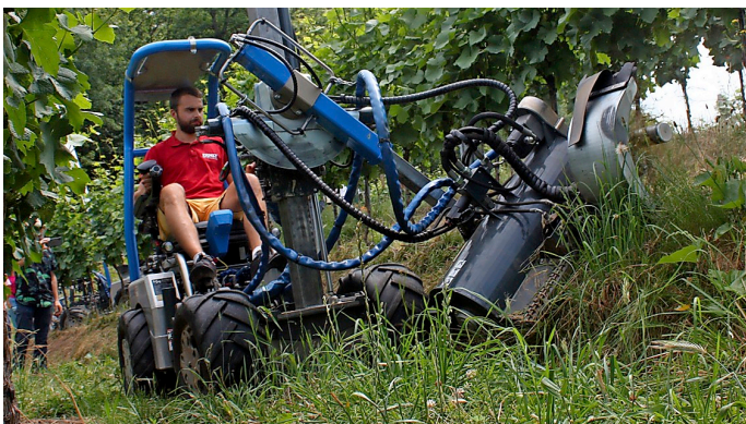
Bild 7: Der bewegliche Vitrac mit Schlegelmulcher, an dem seitlich ein Fadenkopf angebracht ist, wird hier an einer Böschung der Querterrasse eingesetzt.
