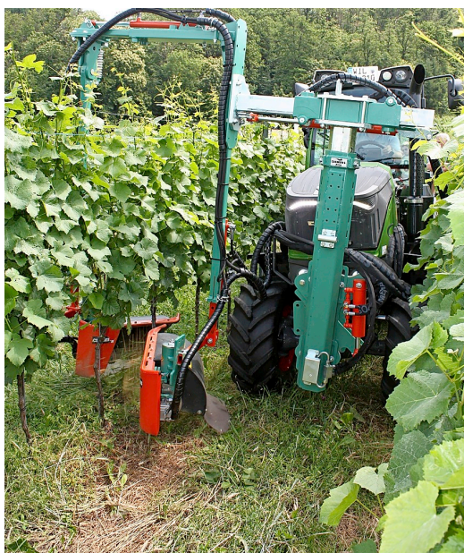
Bild 2: Die Stockbürste von Clemens entfernt von beiden Seiten Beikraut und Stockastriebe.
