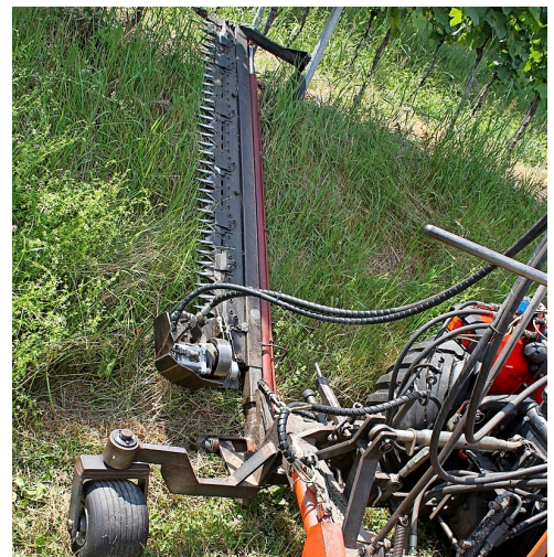
Bild 9: Eigenbau-Böschungsmäher von Franz Benz. Durch die zwei unterschiedlich langen Messerbalken können verschiedene hohe Terrassenböschungen abgemäht werden.
