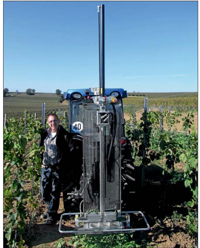
Bodenprobegerät „Profi 90“ der Firma Fritzmeier Umwelttechnik, das an einen Schmalspurschlepper angebaut ist und von dessen Hydraulik versorgt wird. Bilder: Erhardt
