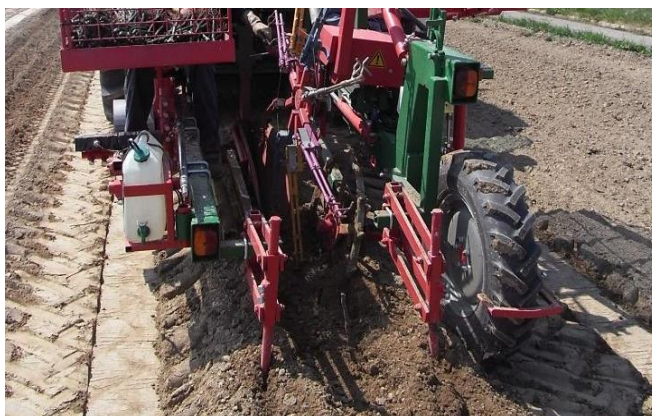
Bild 9: Die Pflanzmaschine benötigt feinkrümelige Boden und hinterlässt Verdichtungen.
